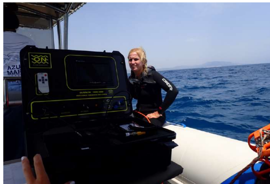
Fotografía 36: Estación para la visualización in vivo de las imágenes de la cámara remolcada
