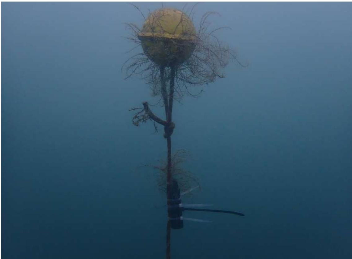
Fotografía 69: Boya de flotación para mantener el sensor a 5 m de profundidad
