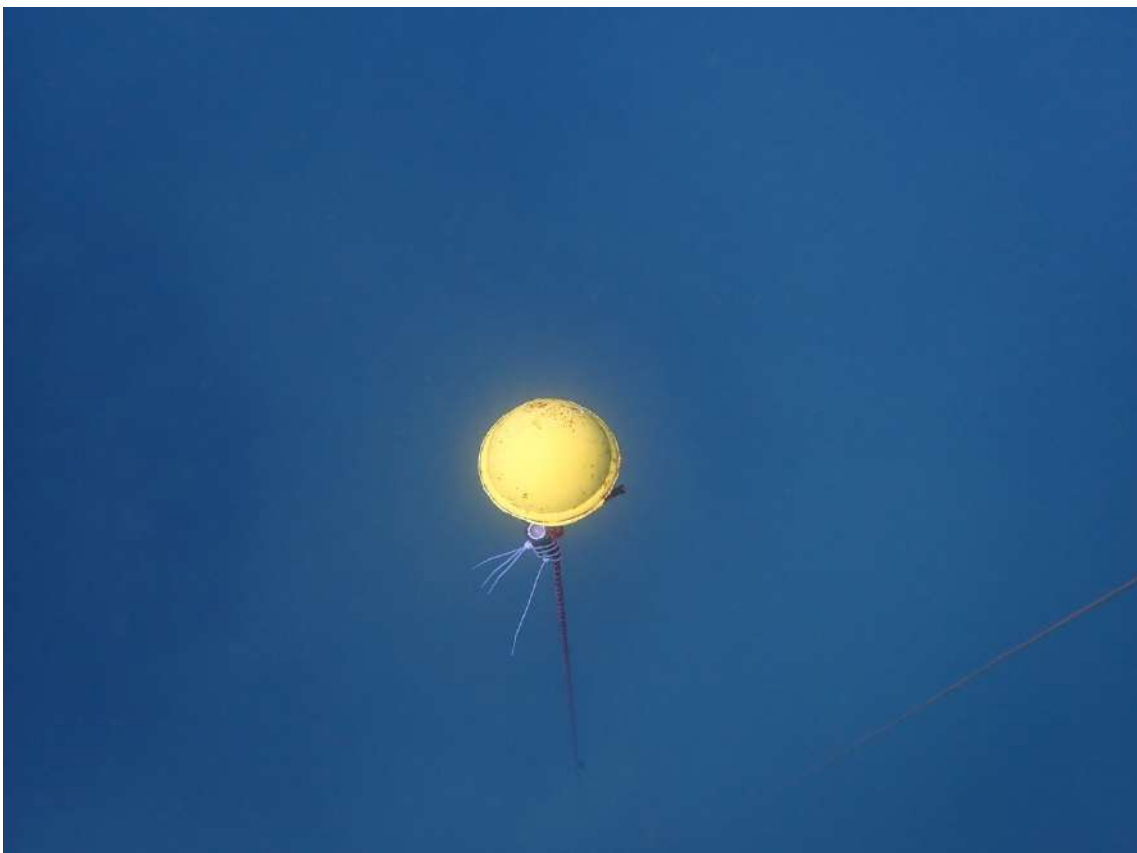
Fotografía 70: Aspecto de la boya desde arriba, usada para mantener el sensor a 5 m de profundidad
