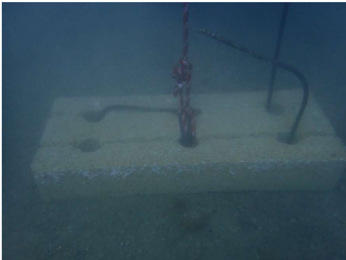
Fotografía 4: Muerto de fondeo utilizado para anclar el sensor de temperatura
